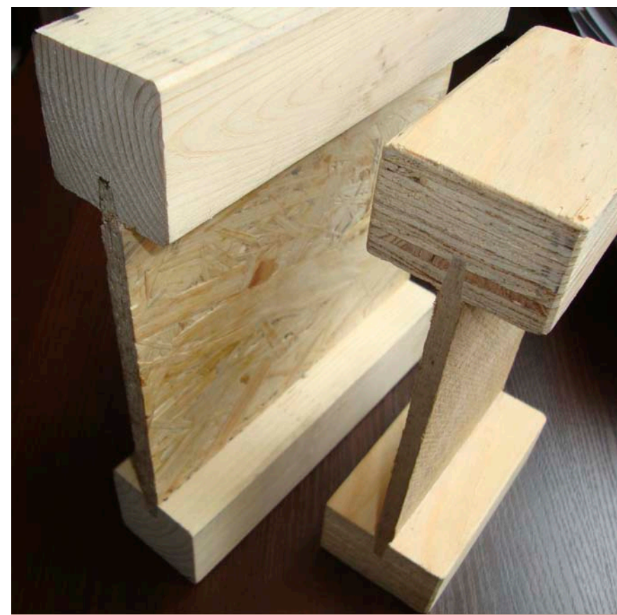
Fot. 1. Przykłady belek dwuteowych: pasy z drewna litego i środnik z OSB, pasy z LVL i środnik z płyty pilśniowej utwardzonej.
