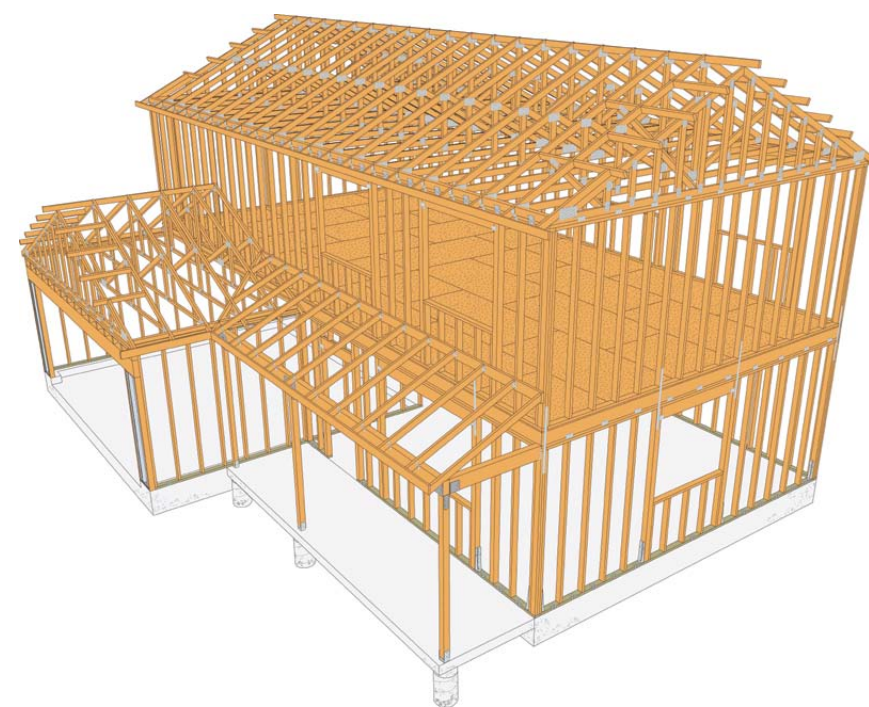
Zdj. 3. Budynek szkieletowy o konstrukcji platformowej
