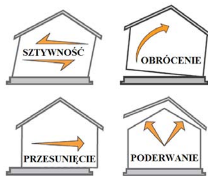
Rys. 1. Modele zniszczenia uwzględniane przy budynkach szkieletowych.
